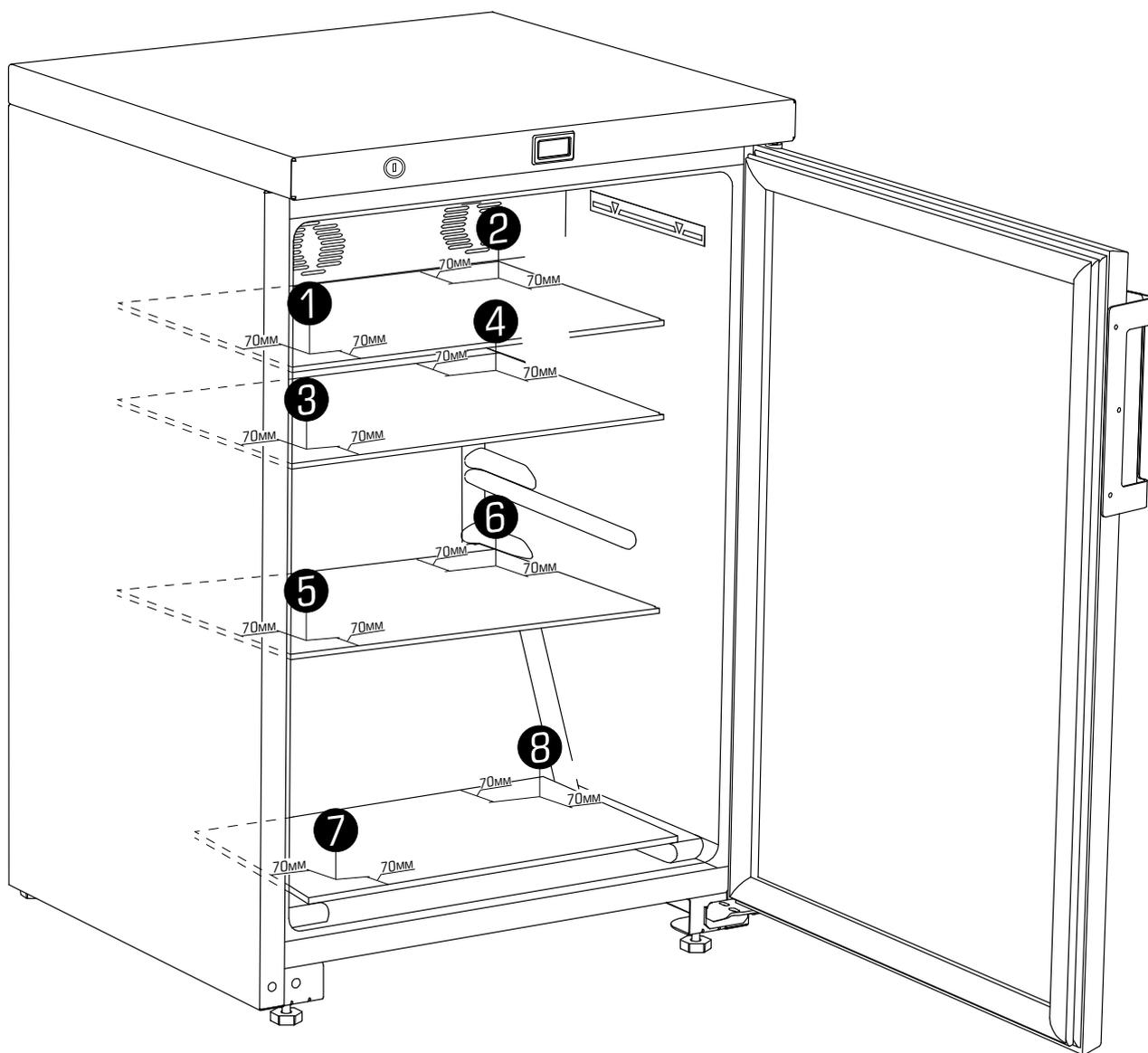
Температура окружающей среды +25 °С. На предприятии установлена температура +4 °С. Значение рабочего диапазона  $\pm 2$  °С.
