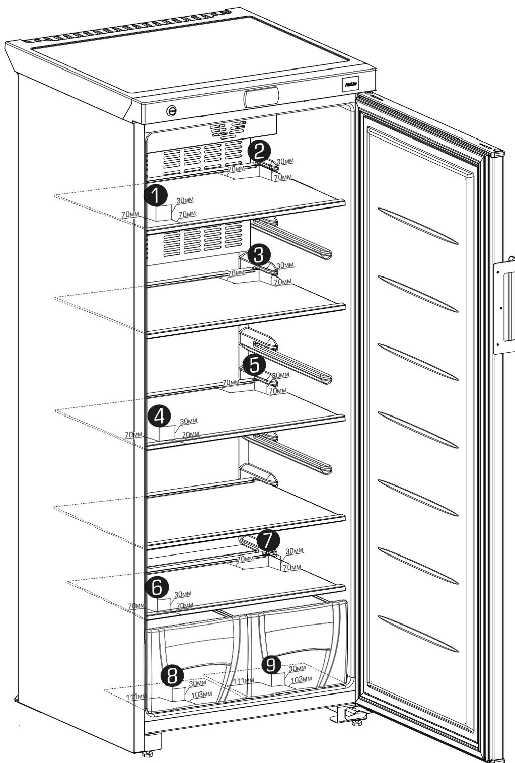
Температура окружающей среды +25 °С. На предприятии установлена температура +4 °С. Значение рабочего диапазона  $\pm 2$  °С.
