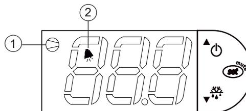
Выключение и включение контроллера осуществляется нажатием и удержанием в течение 3 секунд кнопки «
